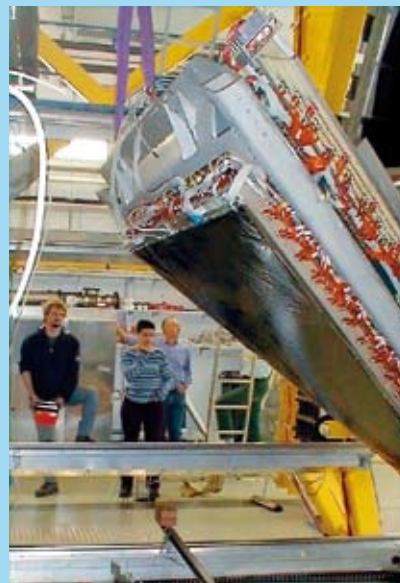
Instalace mnohohrátových driftových komor za magnetem.
