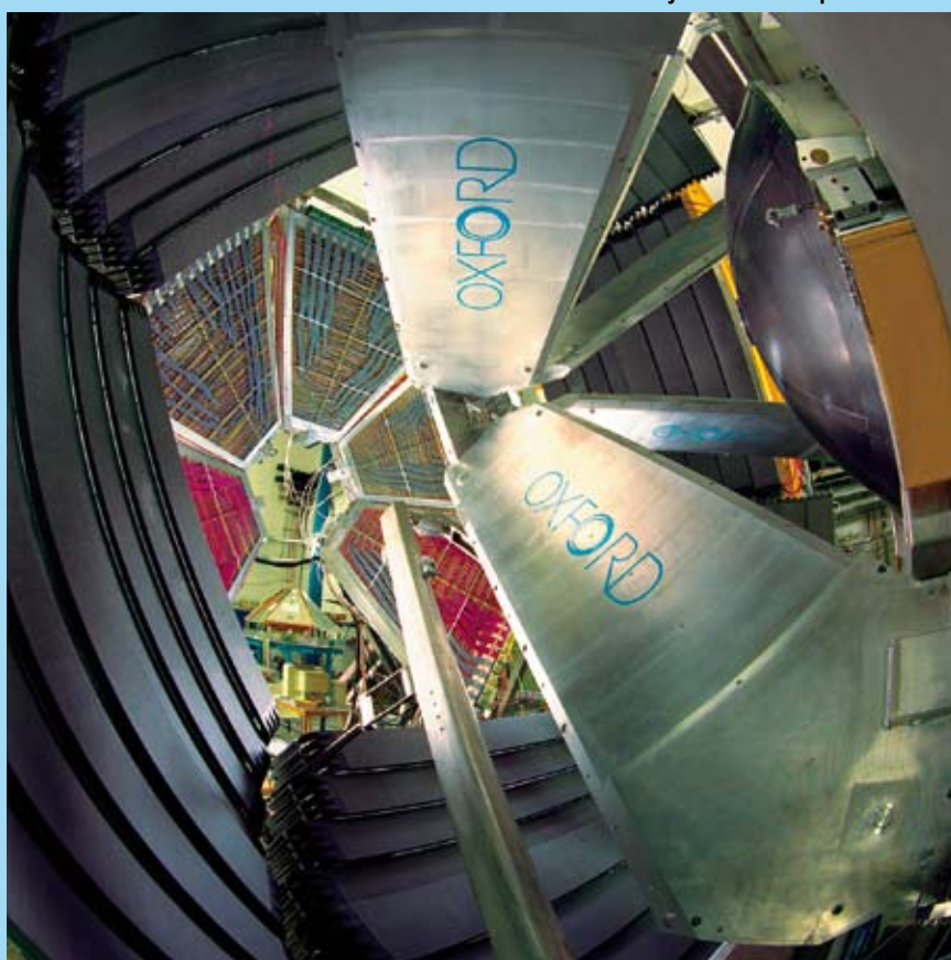
Instalace mnohohrátových driftových komor za magnetem.
