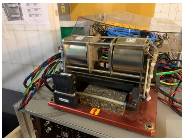
Magnet pro neutronový malouhlový difraktometr MAUD.
